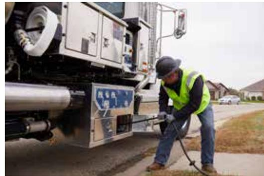
Todas las válvulas de agua están ubicadas en la misma estación de control en el medio del barco, lo que reduce la cantidad de caminatas de ida y vuelta alrededor del camión por parte del operador.
